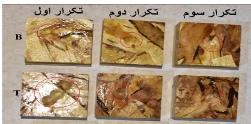
شکل ۱۵. تصویر سطوح کفپوش بعد از اعمال نیرو در آزمون سختی سطح
