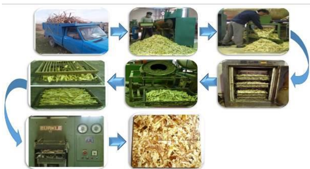
شکل ۲. فرایند ساخت تخته تراشه جهت‌دار از بقایای هرس درختان
