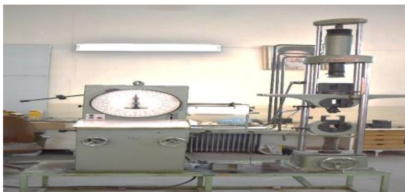
شکل ۶. دستگاه کشش/فشرده‌گی (D-6700) برای آزمون سختی سطح کفپوش‌ها
