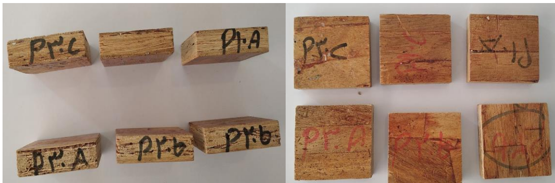
شکل ۲. نمونه‌های آزمایشی خواص فیزیکی و مکانیکی
