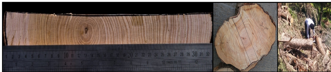
شکل ۲. مراحل تهیه نمونه و مغزی آشکار شده با سنباده
