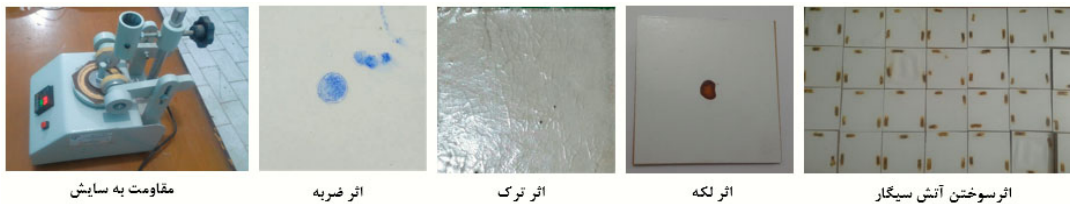
شکل ۲. تصویری از سطح نمونه های روکش آزمون شده و دستگاه سنگش اثر سایش
