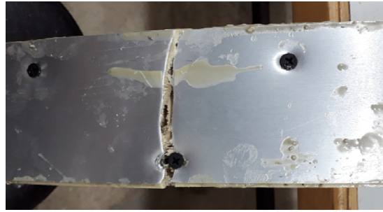
ه) شکست برشی و ترد ورق آلومینیوم در اثر کشش شکل ۴. مدهای شکست در گلولام‌های بررسی شده
