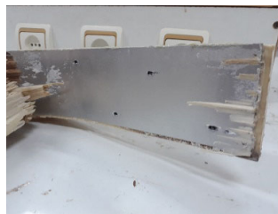
د) شکست برشی پیچ در اثر تنش برشی بین لایه‌ها
