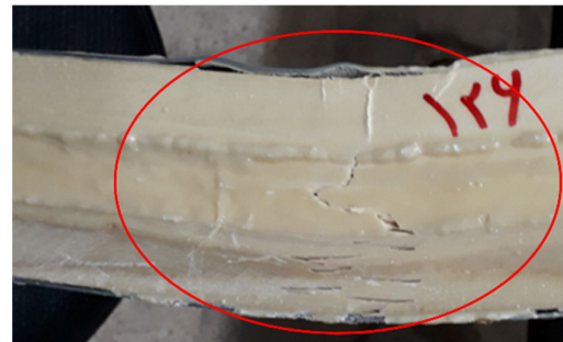
گلولام تقویت‌شده با ورق فولاد کالوانیزه با آرایش ۲
