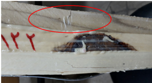
ب) شکست فشاری در گلولام (گلولام تقویت‌شده با ورق فولاد کالوانیزه با آرایش ۱)
