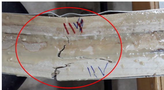
گلولام تقویت‌شده با ورق آلومینیوم با آرایش ۳
