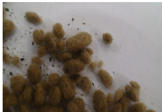
شکل ۱. الیاف پشم سنگ تهیه‌شده پیش از تمیزسازی
