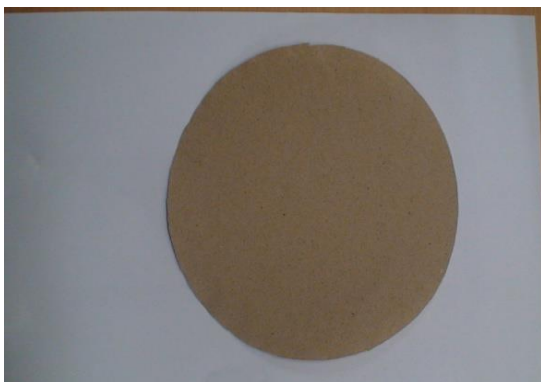
شکل ۲. کاغذ دست‌ساز حاوی الیاف معدنی
