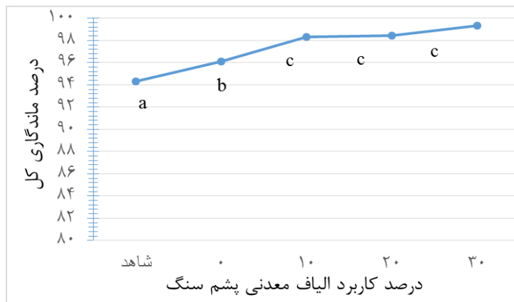
شکل ۷. تأثیر الیاف پشم سنگ بر ماندگاری کل کاغذ NSSC
