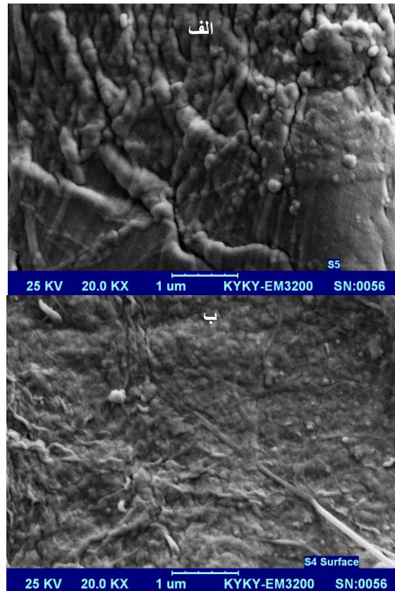
شکل ۵. (الف) سطح کاغذ تیمارشده با نانورس همگن شده بدون کمک‌نگهدارنده؛ (ب) سطح کاغذ تیمارشده با نانورس همگن شده با کمک‌نگهدارنده
