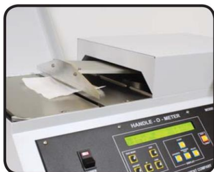
شکل ۱. نمایی از روش اندازه‌گیری سفتی کاغذ براساس استاندارد ASTM-D6828
