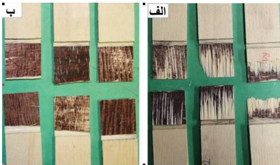
شکل ۴. میزان شکست چوب در محل آزمون تعدادی از نمونه‌های چسب ۴۰ درصد تانن + ۴ درصد اسید بوریک + ایزوسیانات - الف) در حالت خشک؛ ب) در حالت تر
