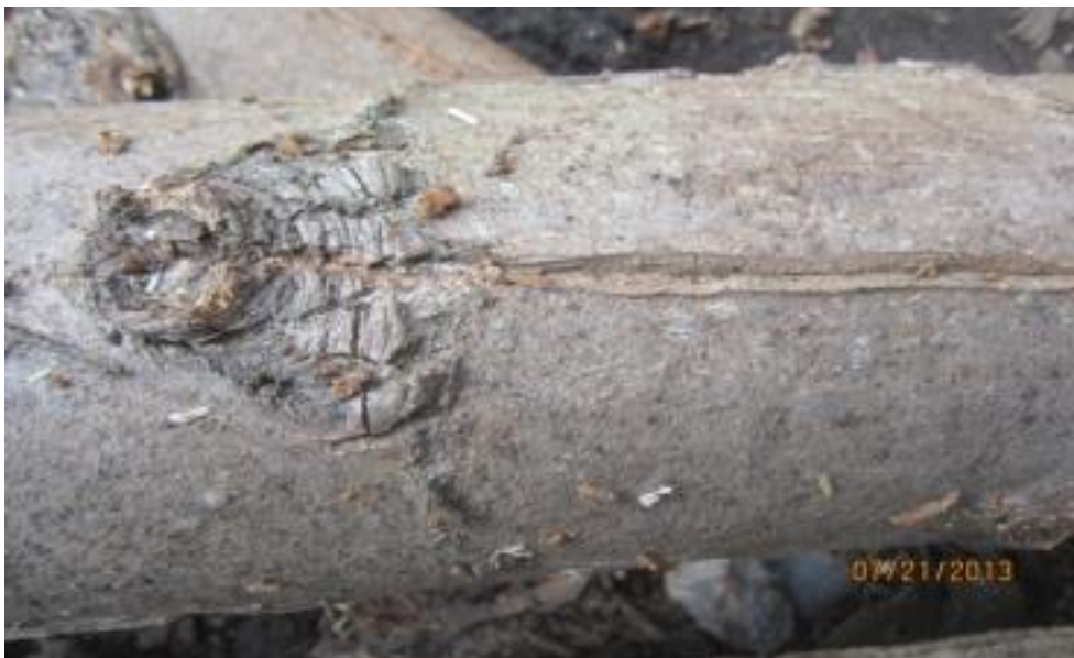
شکل ۳. شکاف یا میلۀ یخ‌زدگی به همراه برآمدگی گره بر روی تنه گرده کم‌قطر صنوبر
