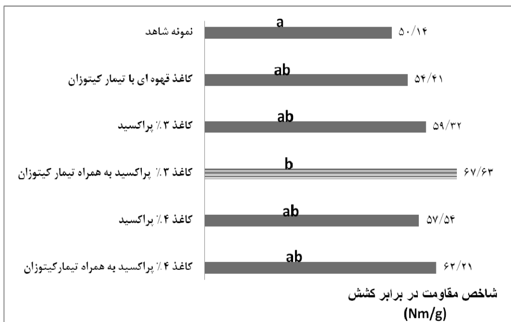
شکل ۴. اثر کیتوزان در تیمارهای متفاوت بر شاخص مقاومت در برابر کشش کاغذهای دست‌ساز
