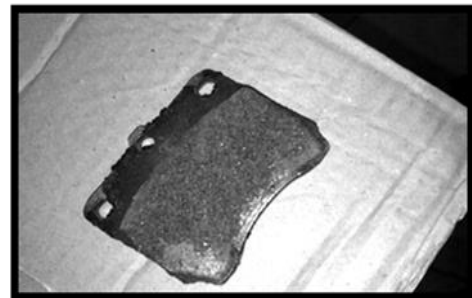
شکل ۶. گسیختگی داخلی لنت ترمز بر اثر آزمون مقاومت برشی
