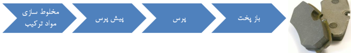
شکل ۱. مراحل ساخت نمونه‌های لنت ترمز
