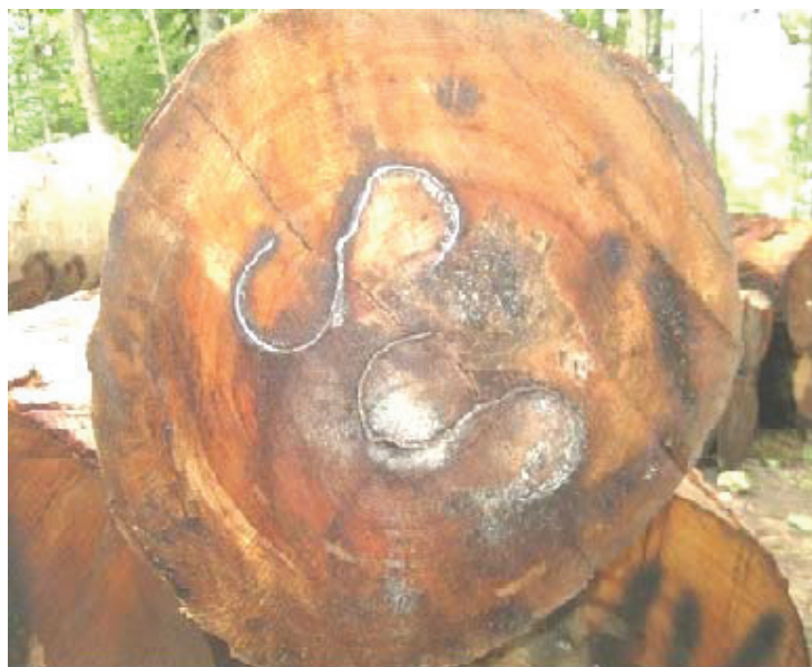
شکل ۱. نمایی از عملیات S کوبی روی مقطع گرده بینه راش
