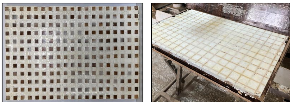
شکل ۳. نمونه هیبریده شده هسته مشبک پیوسته (سمت راست) و هسته مشبک ناپیوسته (سمت چپ)
