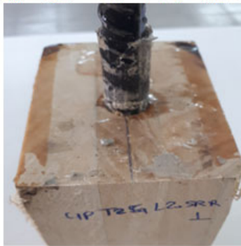
(d) شکست در فصل مشترک میلگرد / چسب
