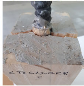
(f) شکست ترک دار نزدیک به فصل مشترک چسب
