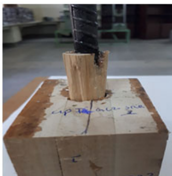
(a) بیرون آمدگی میلگرد همراه با دسته ای از الیاف چوبی
