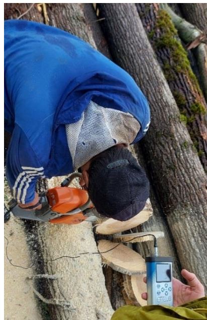
شکل ۱. اندازه‌گیری ارتعاش با استفاده از دستگاه ارتعاش‌سنج SVANTEK 106 A
