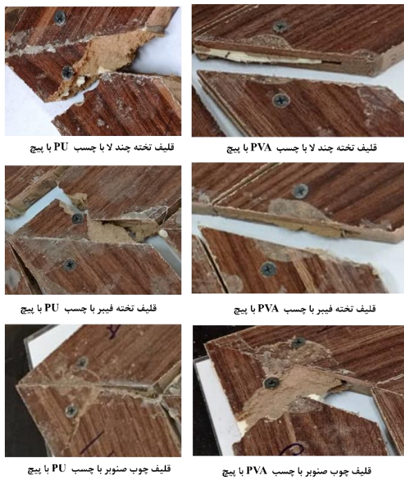
شکل ۷. شکست در نمونه‌های اتصال با چسب به‌همراه پیچ به‌عنوان اتصال‌دهنده مکانیکی
