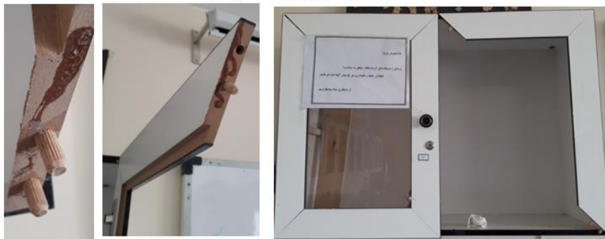
ب: شکست اتصال فارسی قاب سکوبندی آزمایشگاه
