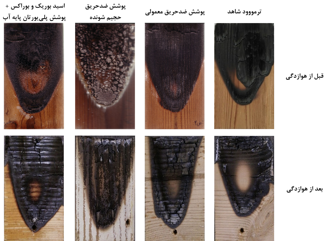
شکل ۶. ترمووود شاهد و پوشش‌خورده پس از پایان آزمون آتش، قبل و بعد از هوازدگی
