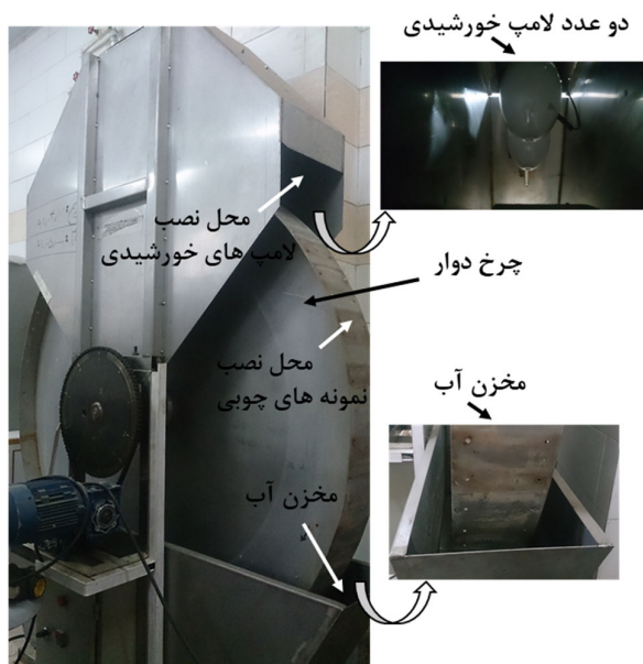
شکل ۱. دستگاه هوازدگی تسریع شده گاردنر
