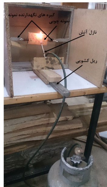
شکل ۲. تجهیزات آزمون مقاومت به آتش و مشخصات آن
