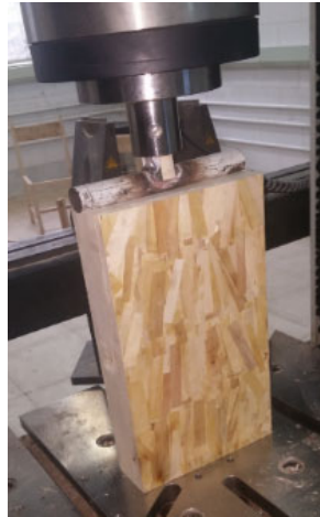
شکل ۳. آزمون فشار محوری روی پانل‌های عایق ساختمانی
