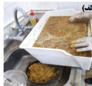
شکل ۱. فرایند ساخت تخته‌خرده باگاس: (الف) تیمار قلیایی با هیدروکسید سدیم؛ (ب) تشکیل کیک همسان؛ (ج) دستگاه پرس
