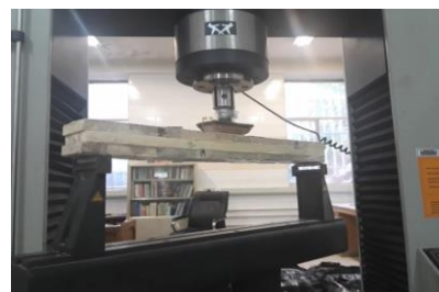
الف) آزمون خمشی جهت طولی پانل
