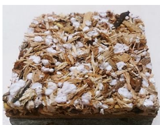
شکل ۴. سطح شکست نمونه‌های چسبندگی داخلی حاوی گرانول با میانگین بیشتر (سمت راست) و قطر کمتر (سمت چپ)
