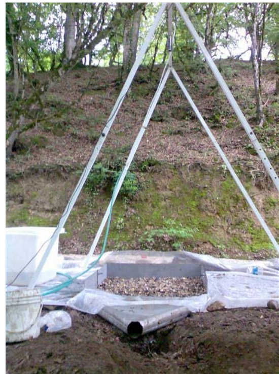
شکل ۲. استقرار باران‌ساز به‌همراه پلات فرسایشی در روی بستر جاده به‌منظور اندازه‌گیری مقدار رسوب و رواناب
