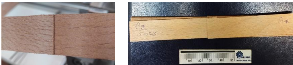
شکل ۱. نمونه همپوشان (Lap-Joint) ساخته شده براساس استاندارد ASTM D7998
