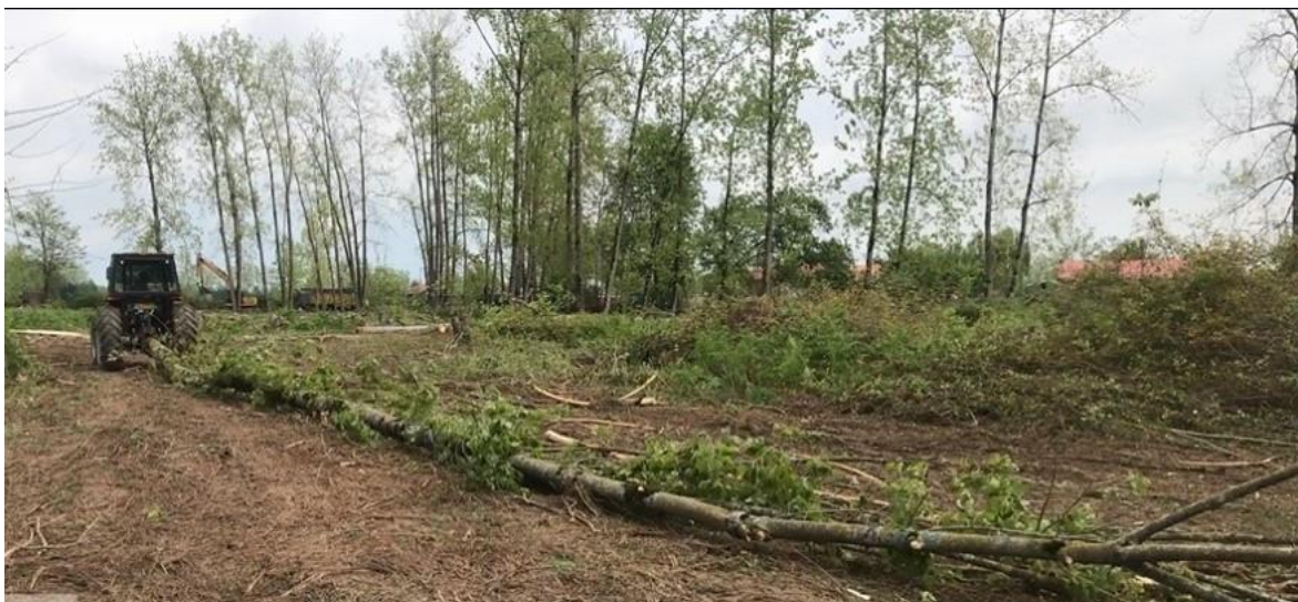
شکل ۲. خروج چوب به روش تمام درخت با تراکتور کشاورزی ITM 800 4WD در منطقه مورد مطالعه
