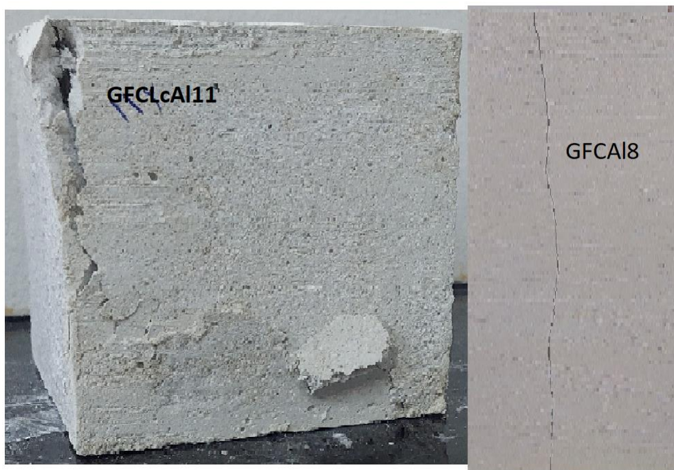
شکل ۳. نحوه شکست نمونه‌های خمشی (GFCAI8) و فشاری (GFCLcA111)
