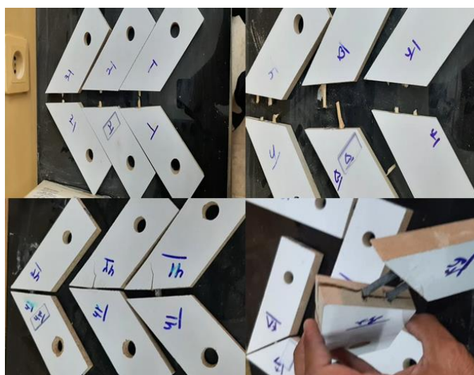
شکل ۷. مد شکست در نمونه‌های ساخته شده با MDF
