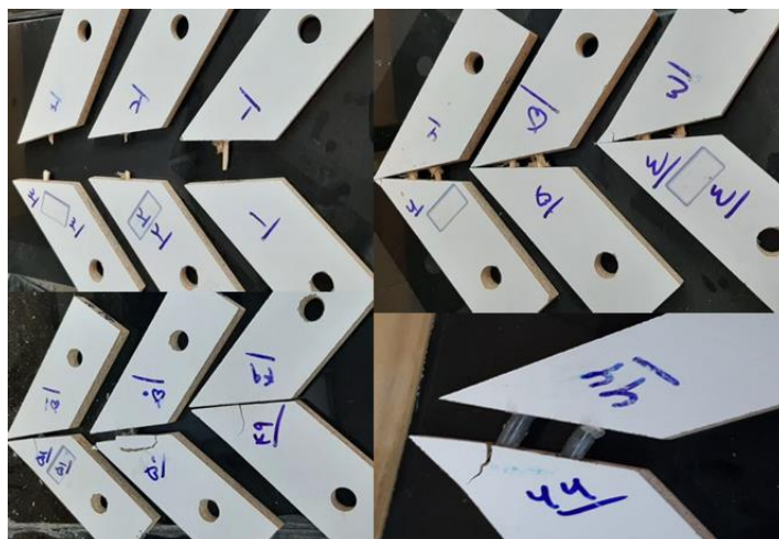
شکل ۶. مد شکست در نمونه‌های ساخته شده با تخته خرده چوب
